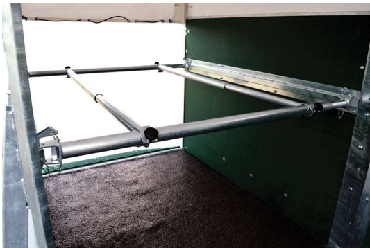
Innenansicht: Teleskopstangen zum Einzeltiertransport
