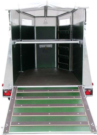
Rückansicht: Rückwand als Laderampe geöffnet
