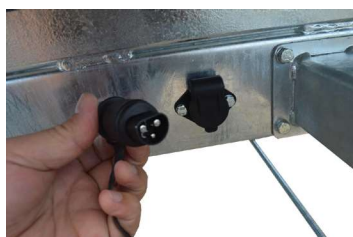
Ladestecker DIN 9680 für externes Ladegerät
