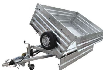
Bordwände Stahl, Höhe 400mm, Aufbau- und Aufsatzwandgarnitur sind 3-seitig klapp/pendelbar, alle Wände abnehmbar, Eckrungen gesteckt
