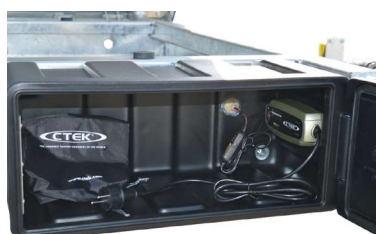
Batterie und Ladegerät on Board zum Anschluss an 230 V Steckdose
