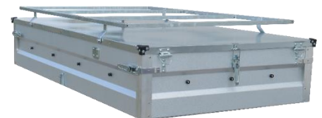
Reling - NEU! für Stahl- und Aludeckel, geeignet für die Leichte, Verstärkte und Geschweißte Ausführung, max. 70 kg belastbar siehe Seite 36
